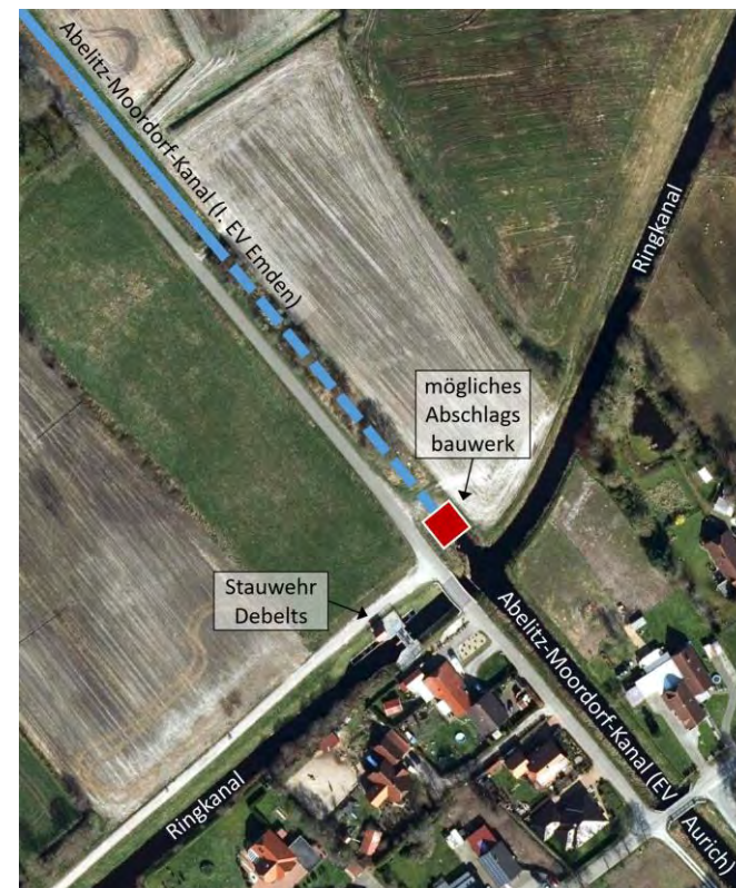
Abb. 45: Möglichkeit zur Schaffung eines Abschlagsbauwerks am Ringkanal oberhalb des Stauwehres Debelts (Orthophoto: LGLN)
